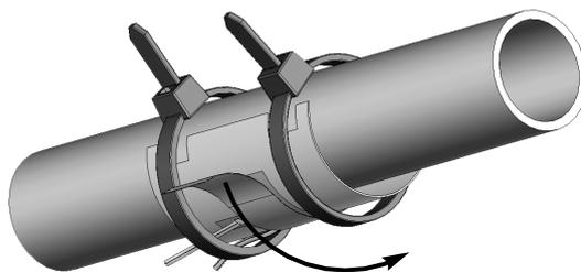
**Achtung!** Sensoroberfläche darf nicht berührt werden. Schutzfolie nach der Montage abziehen.
