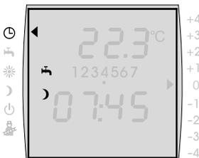
Nach einigen Sekunden schaltet das Display auf die Grundanzeige um. In der Statusanzeige blinkt das Symbol **Absenkbetrieb** ☾ bzw. das Symbol **Standby-Betrieb** ⏻, wenn die ECO-ABS-Funktion das Heizgerät in den Standby-Betrieb schaltet.
