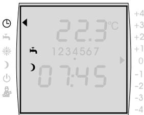
Nach einigen Sekunden schaltet das Display auf die Grundanzeige um. In der Statusanzeige blinkt das Symbol **Warmwasser**
