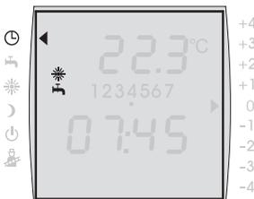
Nach einigen Sekunden schaltet das Display auf die Grundanzeige um. In der Statusanzeige blinkt das Symbol **Heizbetrieb**
