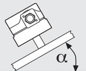
Bei Einbau in einer Zwischeneinbaulage schaltet der Druckwächter bei einem vom eingestellten Sollwert maximal  $\pm 0,5$  mbar abweichenden Druck.
