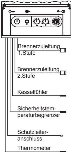
Bei der Montage der Regelung ist zu beachten, dass die Fühlerkapillaren nicht geknickt oder verdreht werden!
