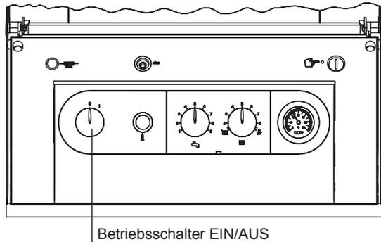
Wird die Regelung am Betriebsschalter eingeschaltet, so wird mit der Werkseinstellung der Betrieb der Heizungsanlage aufgenommen.
